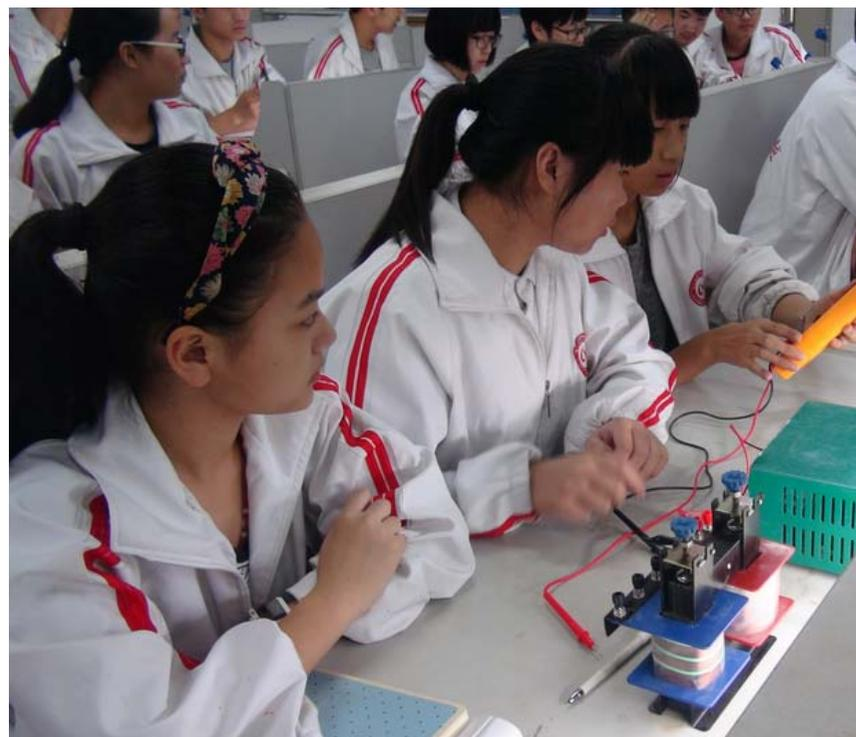
保持原线圈电压 $U_1$ 和匝数 $n_1$ 不变，改变副线圈匝数 $n_2$ ，研究副线圈匝数 $n_2$ 对副线圈电压 $U_2$ 的影响
