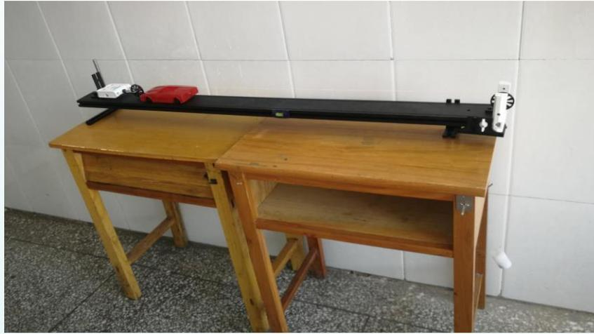
1、实验器材：支撑杆、小车、光电门传感器、力传感器、滑轮、细线、砝码筒、砝码、数据采集器和计算机。
